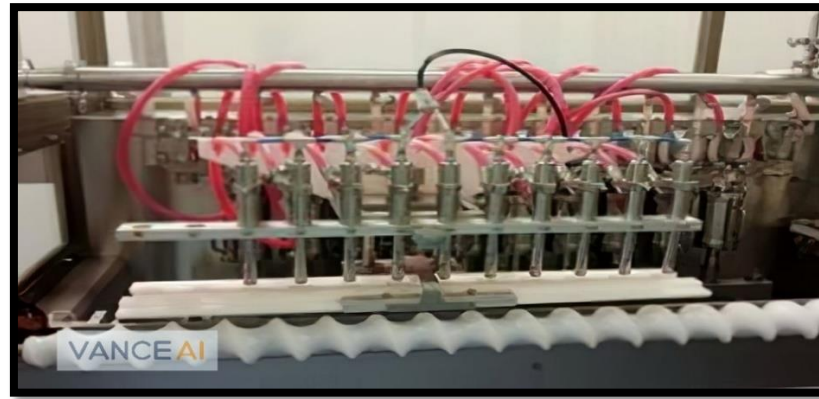
Figure 30 Ligne de remplissage et de sertissage.
